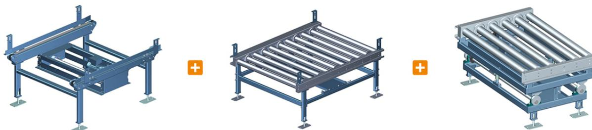
该系统主要由链式输送线、滚筒输送线、顶升移栽机组成。
